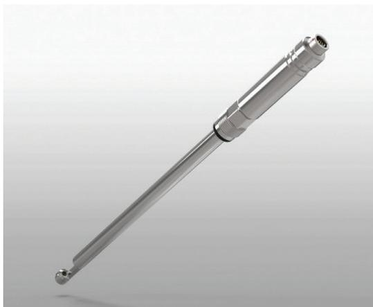
EXcell 231 é um sensor digital de absorvância NIR de alta precisão para monitorar processos de produção nas indústrias de biotecnologia, alimentos e farmacêutica. Seu design de aço inoxidável de 12 mm e janelas de safira anti-desgaste tornam o EXcell 231 um sensor confiável e inteligente com amplificador digital integrado.
