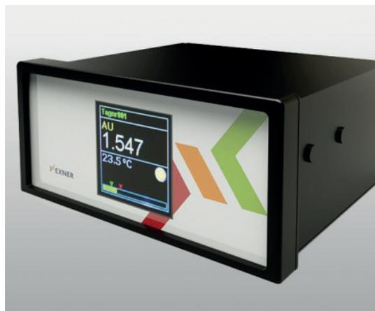
A interface de comunicação ECI-03 Exner converte os valores medidos dos sensores ópticos EXcell em uma interface padronizada de 0/4 ... 20 mA e fornece a tensão necessária para o sensor. Além disso, um contato de valor limite e um contato de alarme podem ser usados. O display gráfico colorido com função de toque exibe os valores medidos atuais e parametrizações.
