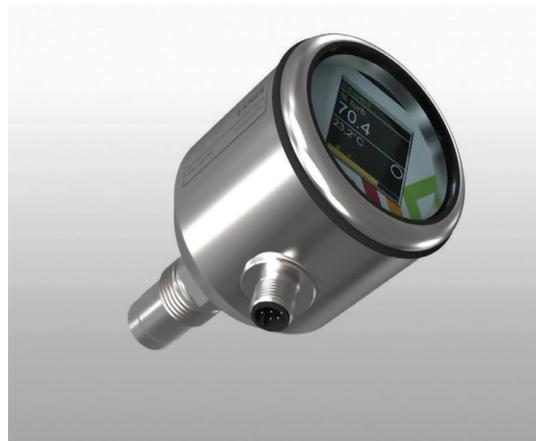
EXcell 241 é um sensor digital de absorvância NIR de alta precisão para soldagem DN25 em soquetes de monitoramento de medição de biomassa em aplicações de biotecnologia, alimentos e farmacêutica. Seu design feito de aço inoxidável, seu soquete soldado padrão DN25 e janelas de safira sem desgaste, sua tecnologia LED e o amplificador digital integrado os tornam um dispositivo de medição confiável.
