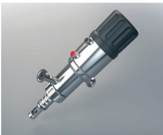
O Extract 830 é um invólucro de sonda retrátil operado pneumaticamente feito de aço inoxidável em um design higiênico para ser conectado a tanques de processo ou tubos. A unidade de acionamento insere o sensor no meio do processo e de volta na câmara de limpeza.
